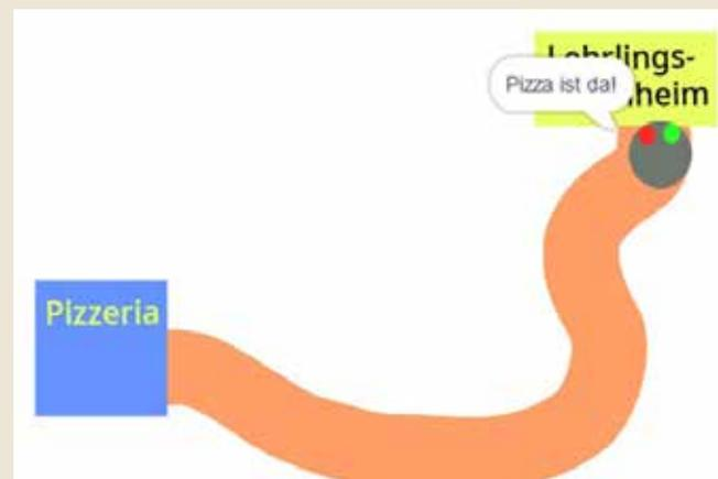
Der Roboter hat zwei „Augen“ (man nennt diese auch „Sensoren“). Mit diesen kann er die braune Farbe des Weges gut vom weißen Beton daneben unterscheiden. Dadurch bemerkt er, wenn er den Weg verlässt.
